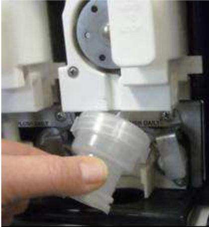
Connecter le téton de la chambre de mélange au tube silicone.
