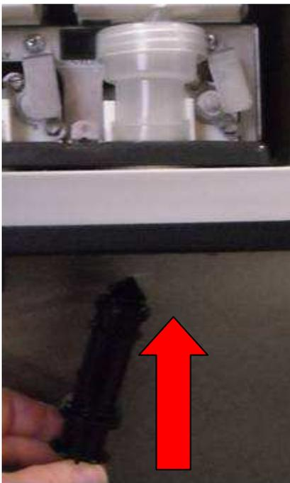
Remettre en place le bec et le mélangeur statique et fermer la porte de l'armoire
