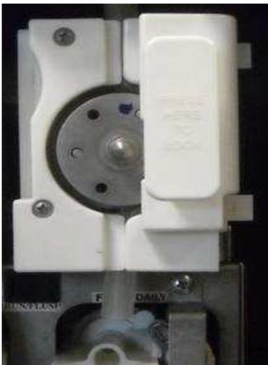
Fermer la pompe avec le bloc coulissant et retirer le bouchon rouge du tube silicone.
