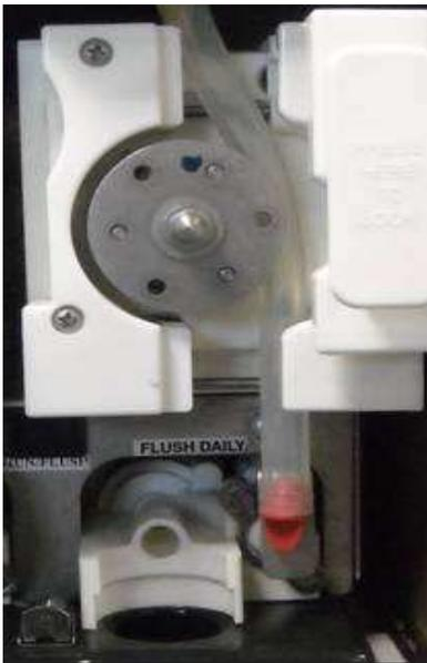
Retirer le bec verseur et le mélangeur, retirer la chambre de mélange et les disposer sur l'égouttoir.
