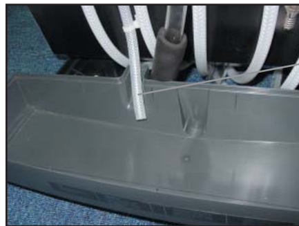
在滴水盘凹口处 放置溢流管
