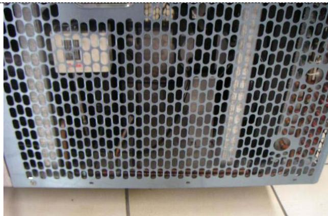
Foto 21: Retire todos los tornillos del panel de servicio (4 en este lado)
