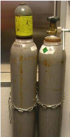
Foto 1: Botella de CO2 con la cadena para mantenerla en posición vertical.
