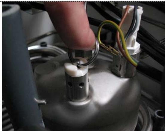
Foto 18: Levante el anillo de la válvula de escape del carbonatador para purgar el aire.
