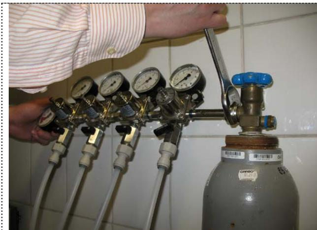
Foto 5: Conecte el montaje del regulador de CO2 a la botella de CO2
