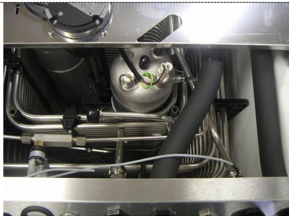
Foto 17: El depósito del carbonatador está en el interior del depósito de agua.
