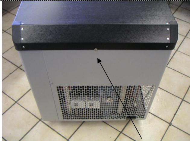
Foto 19: Quite los tornillos de fijación de la cubierta
