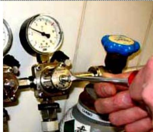
Foto 8: Ajuste la presión girando el tornillo regulador.
